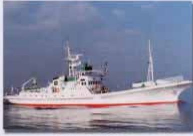
4代みやざき丸 鋼製 169t S62.3竣工 ディーゼル1050馬力 13.73ノット
