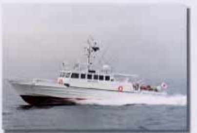
4代たちばな アルミ合金製 45t ディーゼル1385馬力×2 33ノット
