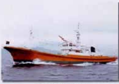
3代みやざき丸 鋼製 294.78t S48.3.20竣工 ディーゼル1300馬力 12.96ノット
