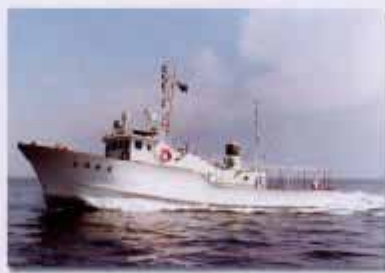
4代しらすぎ FRP製 39.08t S56.3竣工 ディーゼル550馬力 12.0ノット
