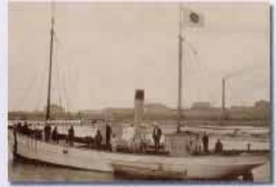
笠狭丸 木製帆船 補助推進用蒸気機関 62.12t T1.10.10竣工 100馬力
