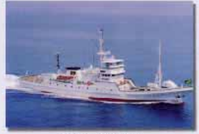
5代みやざき丸 鋼製 199t H15.5竣工 ディーゼル2000馬力 15ノット
