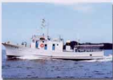
3代たちばな FRP製 49.08t S55.4.19竣工 ディーゼル500馬力 11.6ノット
